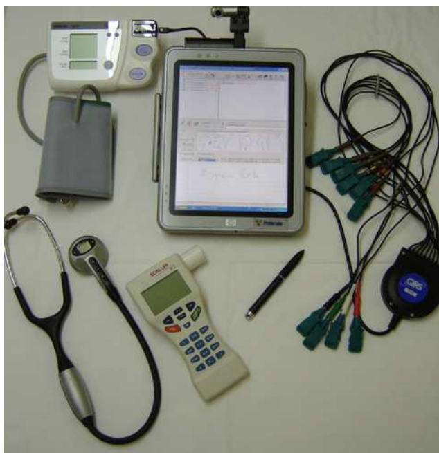
Εικόνα: Το σύστημα τηλεϊατρικής για κατ'οίκον νοσηλεία, που αναπτύχθηκε στο έργο ARI-ACT, το οποίο συντονίζεται από την Περιφέρεια Αττικής.
