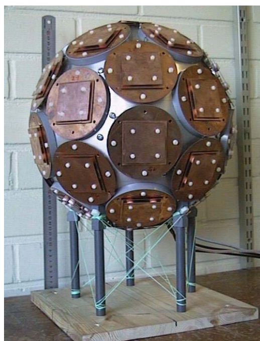
Σχήμα 5.6. Σφαιρική στοιχειοκεραία δέκτη
