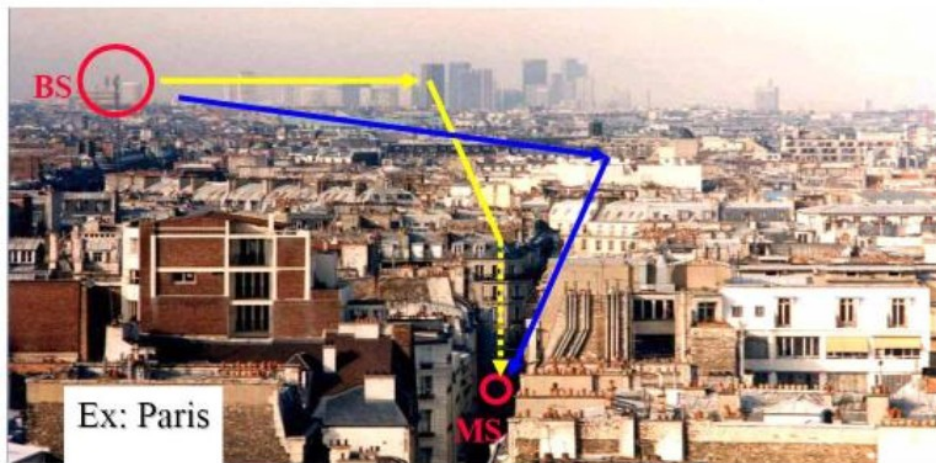
Σχήμα 4.8. Παράδειγμα προεξέχοντων (μακρινών) κτιρίων
