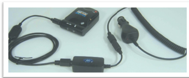
Εικόνα 2. 11: : δέκτης Bluetooth GPS
