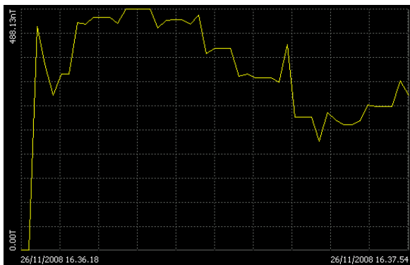
Μέτρηση 146: Αστάθεια με σημαντικές μεταβολές της μαγνητικής επαγωγής και μέγιστο στο 0,797% του ορίου.
