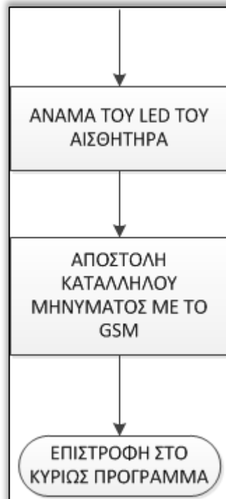
Εικόνα 38. Διάγραμμα ροής interrupt
