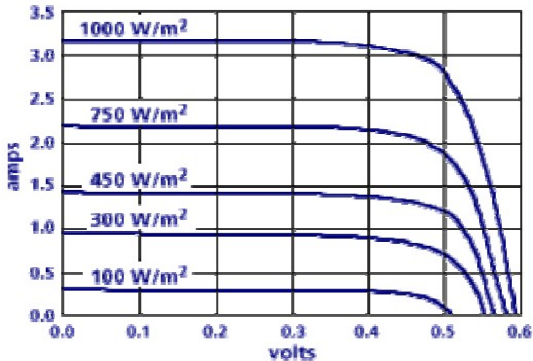
Εικόνα 11. Παραγωγή ρεύματος και τάσης μιας ηλιακής κυψέλης από διάφορες ηλιακές εντάσεις φωτός.
