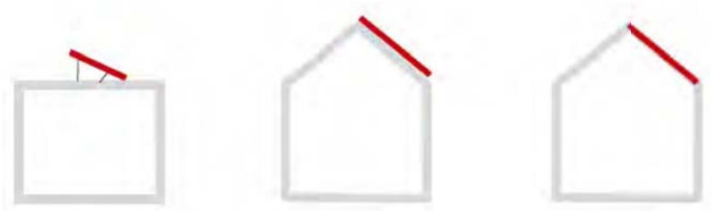
Εικόνα 7 τρόποι ενσωμάτωσης φωτοβολταϊκών πλαισίων σε στέγη
