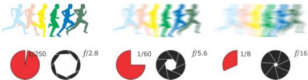
Εικόνα 2.9: Ανάλογα τον χρόνο λήψης η κίνηση καταγράφεται ως παγωμένη ή θολωμένη. Για να διατηρηθεί η φωτεινότητα το διάφραγμα κλείνει.
