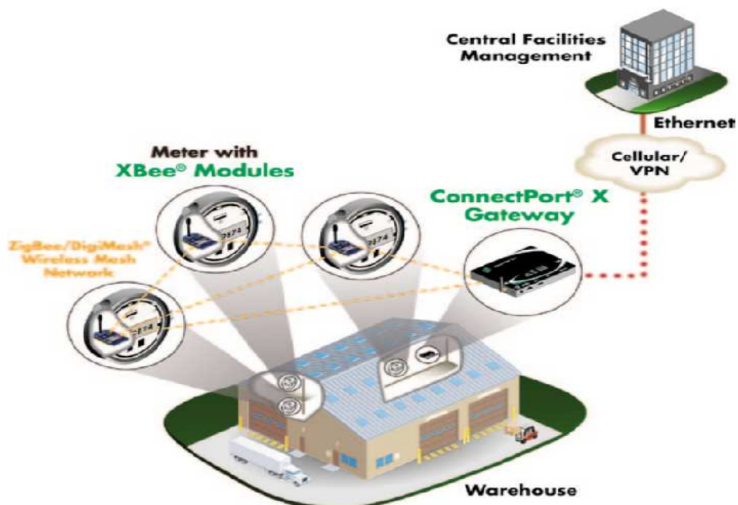
Εικόνα 5: Χαρακτηριστικό παράδειγμα χρήσης δικτύου ZIGBEE / MESH
