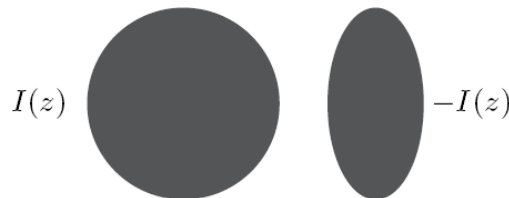
Σχήμα 5.1. Διατομή της γραμμής μεταφοράς δύο αγωγών. Η z -διεύθυνση είναι προς τα έξω (από τη σελίδα). Η I(z) επίσης ρέει προς έξω και -I(z) ρέει προς τα μέσα (στη σελίδα).
