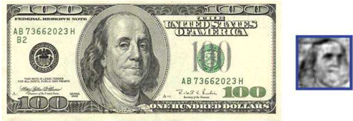
Εικ. 3.8 εικόνα ενός THz κύματος του σήματος του νερού σε ένα χαρτονόμισμα των 100 δολαρίων
