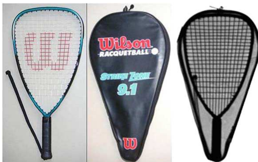
Εικόνα 1.5. (α) η ρακέτα (β) μέσα στην μαύρη πλαστική τσάντα και (γ) απεικόνιση της ρακέτας μέσα στην τσάντα με την εφαρμογή THz κύματος (0.6 THz).
