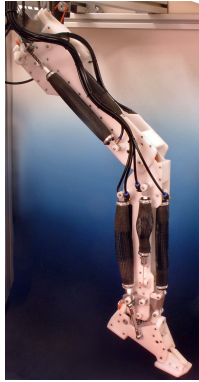
(α) Ρομποτικό πόδι κινούμενο με χρήση αέρα.
