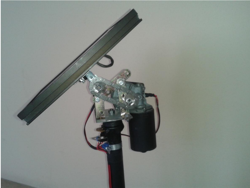
Λεπτομέρεια Μηχανικού Τμήματος Ηλιακού Ιχνηλάτη
