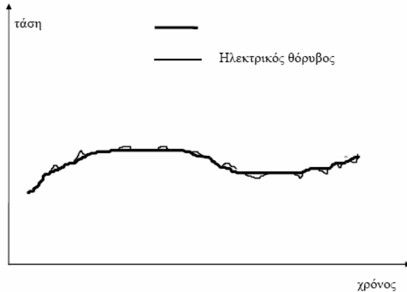
Σχήμα 4.18 Παραμόρφωση του σήματος του οργάνου από τον ηλεκτρικό θόρυβο.
