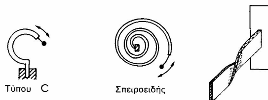
Σχήμα 9.4 Διάφορες μορφές σωλήνων Bourdon.
