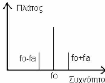
Σχήμα 12.6 Πλευρικές συχνότητες στην διαμόρφωση πλάτους (AM).
