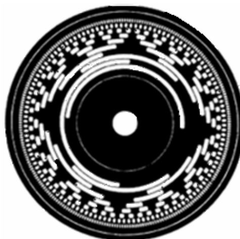
Σχήμα 15 - απόλυτος οπτικός κωδικοποιητής γωνιακής θέσης των 10- bits
