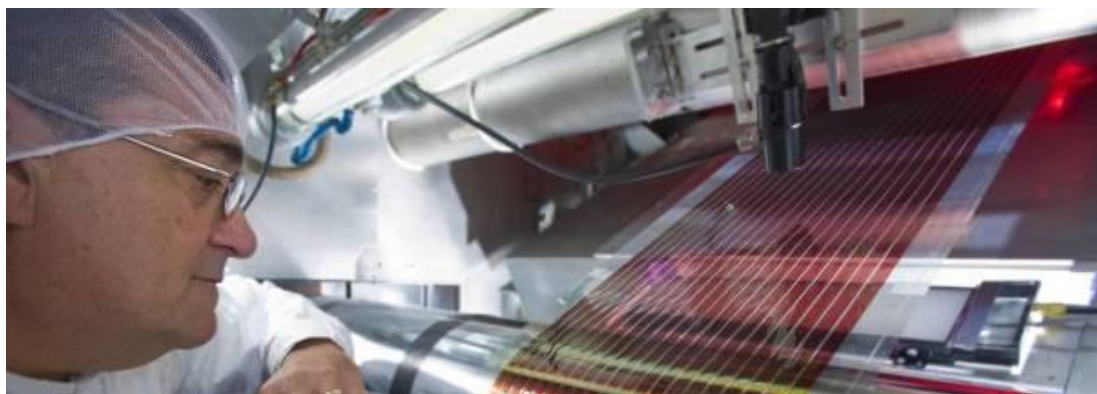
Εικόνα 6: Roll to Roll παραγωγή φωτοβολταικών(πηγή: Konarka)
