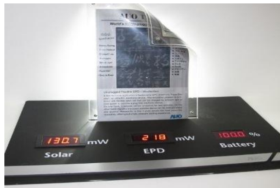
Εικόνα 2:Εύκαμπτο ηλιακό E-reader.Χρησιμοποιεί μια οργανική εύκαμπτη οθόνη TFT μεγέθους 6 ιντσών. Έχει ενσωματωμένη άμορφη μπαταρία βάρους 10γρ και φορτίζει είτε με εσωτερικό είτε εξωτερικό ηλιακό φως με conversion efficiency της τάξεως του 3.6% (πηγή AU Optronics Corp)
