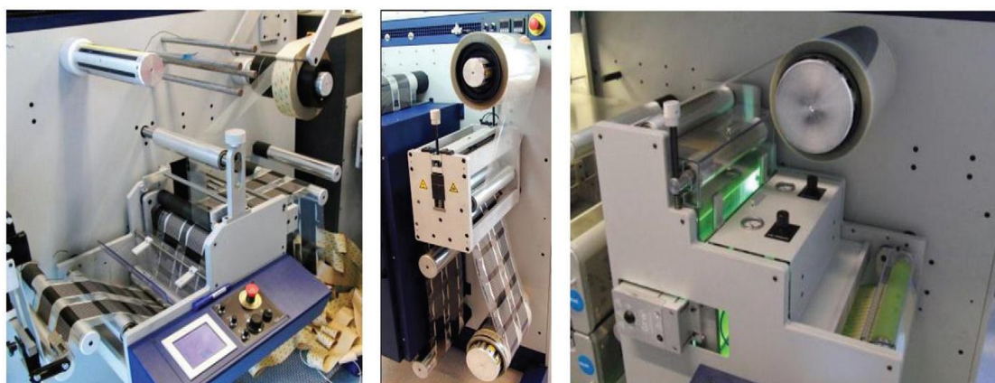
Εικόνα 42: A) Cold Lamination διακρίνονται τα δυο στρώματα επικάλυψης B) Hot-Melt Lamination C) UV lamination
