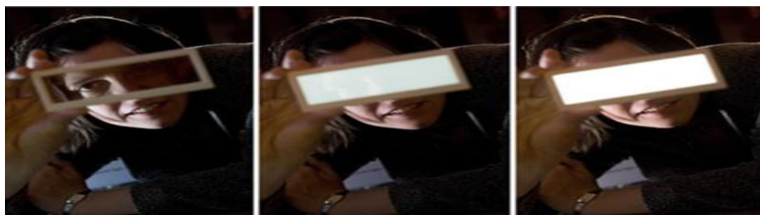
Εικόνα 15: Πρωτότυπο πλακίδιο διάφανου OLED φωτισμού (πηγή philips)
