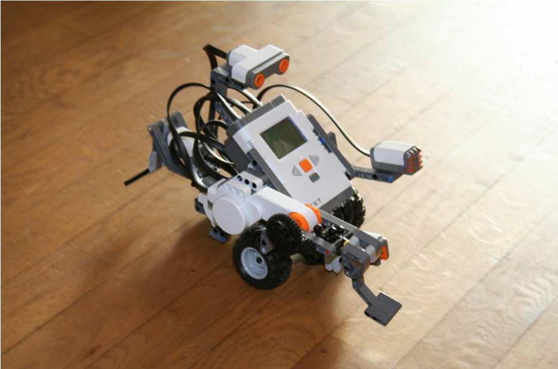
*Εικόνα 4.1 Ένα ρομπότ φτιαγμένο με το LEGO MINDSTORMS NXT [44]*
