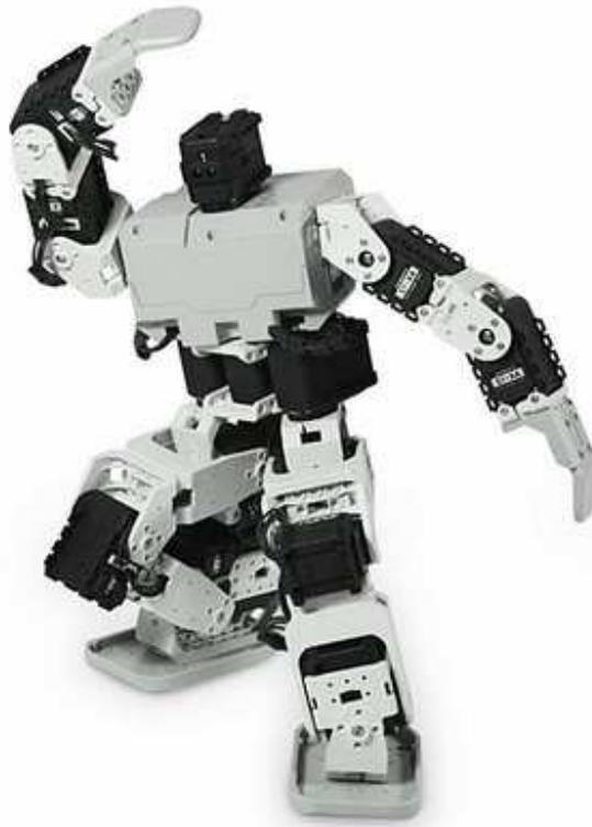
*Εικόνα 4.6 Ένα ανθρωποειδές κατασκευασμένο με το kit Bioloid [57]*
