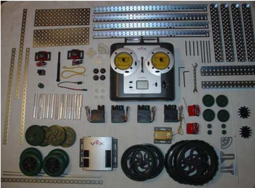
*Εικόνα 4.8 Εξαρτήματα του VEX Robotics Design System [59]*
