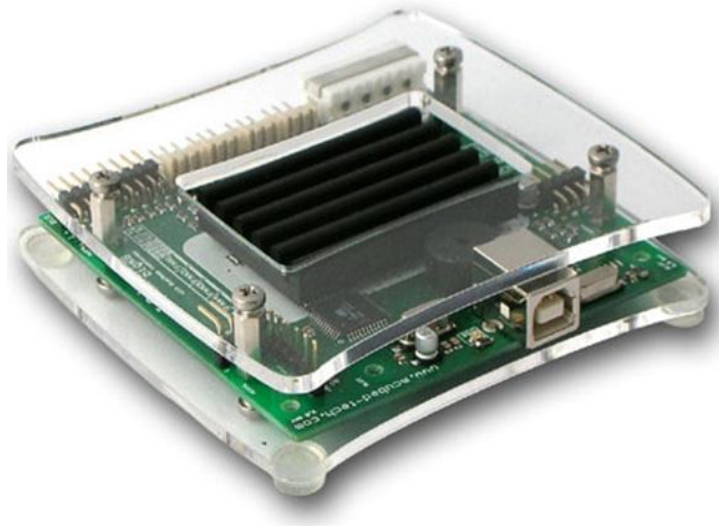
Εικόνα 2.10 : Ο ελεγκτής ψύξης t-Balancer big NG
