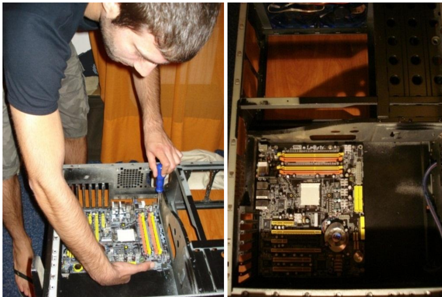
Εικόνα 2.28 : Εγκατάσταση της μητρικής πλακέτας στο κουτί
