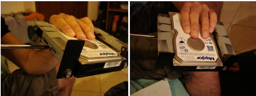
Εικόνα 2.34 : Εγκατάσταση του σκληρού δίσκου στο κουτί
