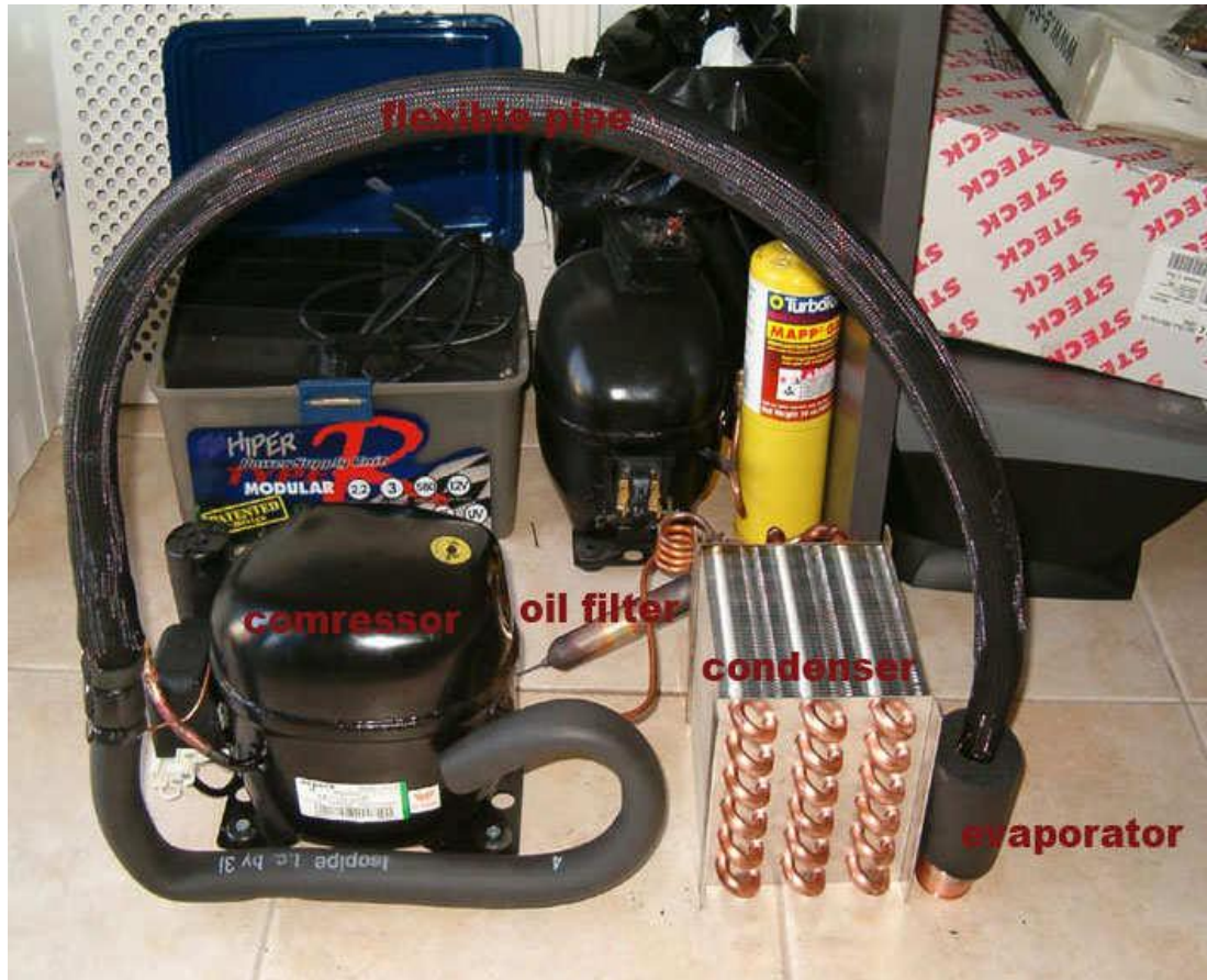
Εικόνα 1.25 : Υλικά κατασκευής ενός Phase Change
