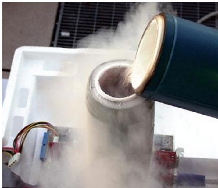
Εικόνα 1.38 : Γέμισμα του κάνιστρου με LN 2 για την ψύξη ενός επεξεργαστή
