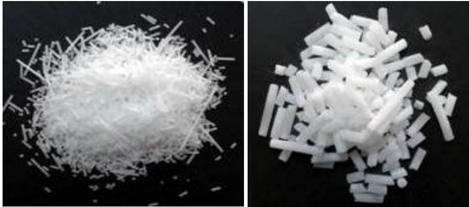
Εικόνα 1.15 : Τρίμματα ξηρού πάγου 3mm (αριστερά) και 16mm (δεξιά)
