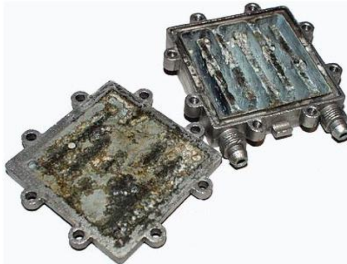
Εικόνα 1.11 : Άλατα πάνω σε μπλοκ λόγω χρήσης μη-αποσταγμένου νερού
