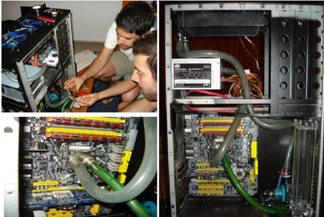
Εικόνα 2.37 : Εγκατάσταση-τοποθέτηση του συστήματος υδρόψυξης
