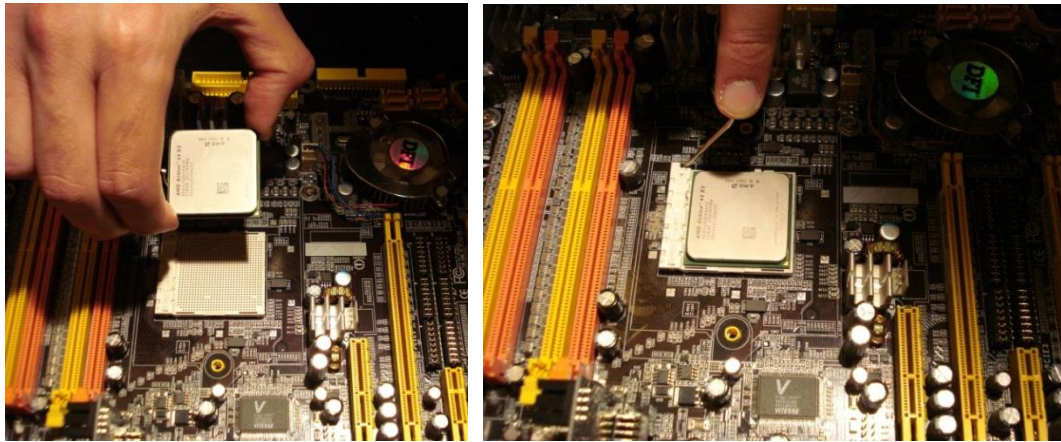
Εικόνα 2.29 : Εγκατάσταση του επεξεργαστή πάνω στη μητρική πλακέτα
