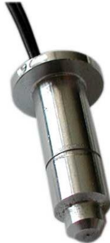
Εικόνα 2.22 : Ο αισθητήρας θερμοκρασίας νερού που χρησιμοποιήθηκε
