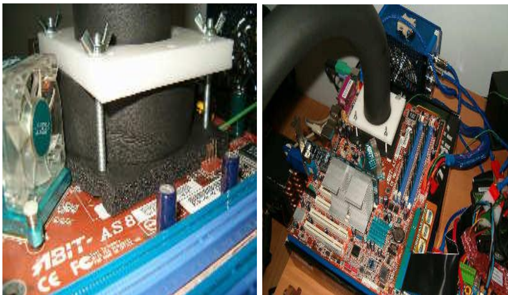
Εικόνα 1.26 : Τοποθέτηση και στήριξη πάνω στον επεξεργαστή
