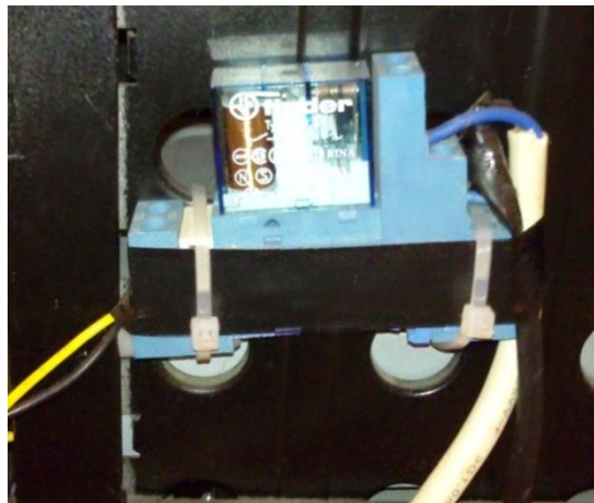
Εικόνα Εικόνα 2.26 : Το ρελέ του Η/Υ μας
