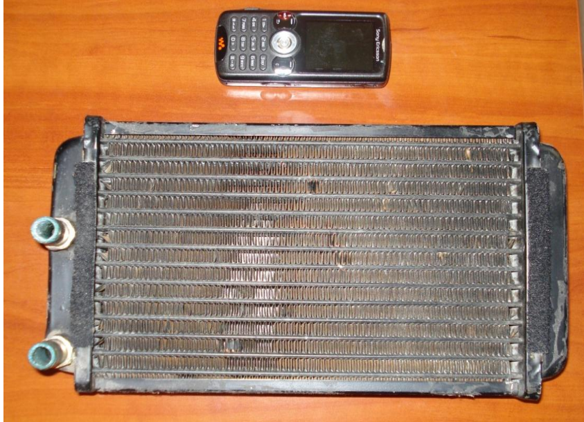
Εικόνα 2.13 : Ψυγείο που χρησιμοποιήθηκε στην υδρόψυξη
