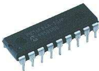
Σχήμα 1.4.3.1: ο μικροελεγκτής PIC16F84A σε κέλυφος DIP18 και το διάγραμμα των ακροδεκτών του.
