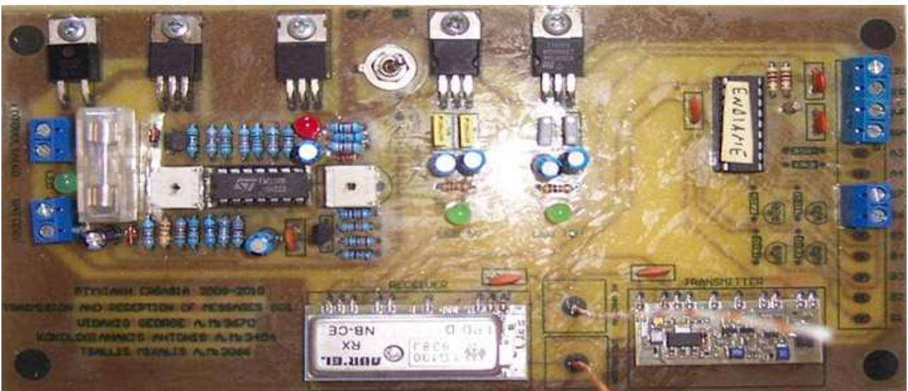
Σχήμα 1.5.3: το κύκλωμα του ενδιάμεσου σταθμού συναρμολογημένο σε εποξική πλακέτα.
