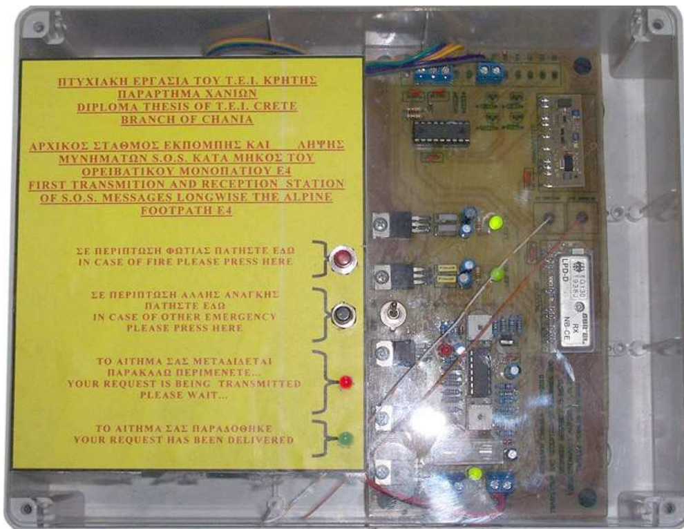
Σχήμα 1.5.5: τα πλήκτρα και οι ενδεικτικές λυχνίες στην πρόσοψη του κουτιού του τερματικού σταθμού.
