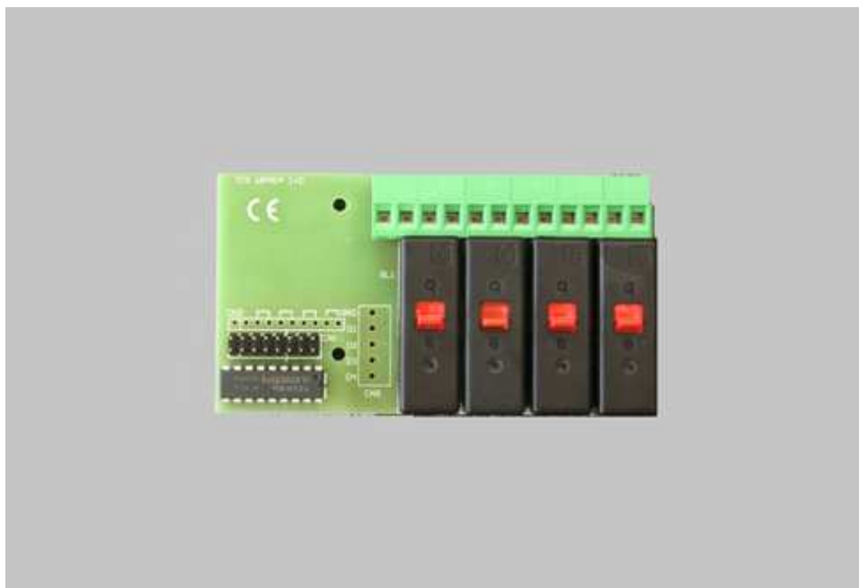
Σχήμα 15. Εντοιχισμένη μονάδα Relays WR-420
