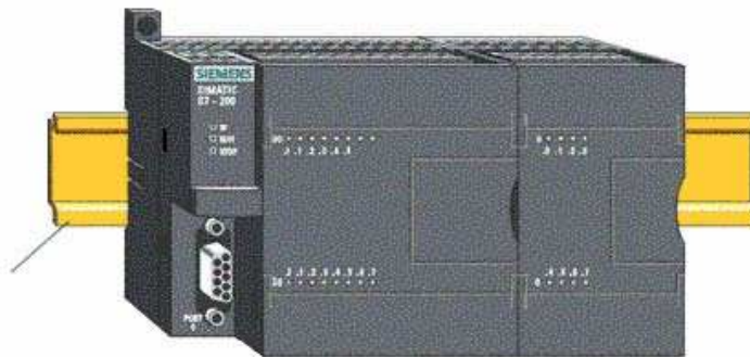
Σχήμα 2.7: Εγκατάσταση του S7-200 σε ράγα
