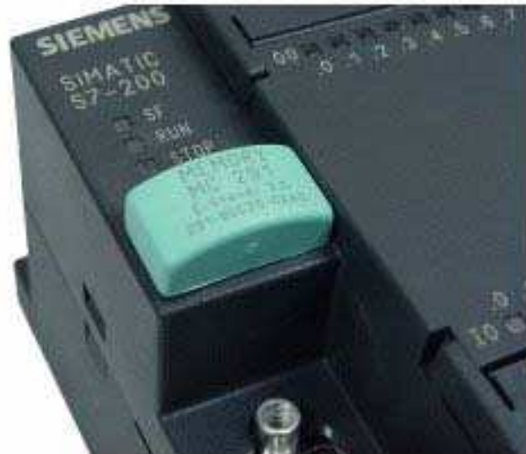
Σχήμα 2.3: S7-200 με εξωτερική μονάδα μνήμης
