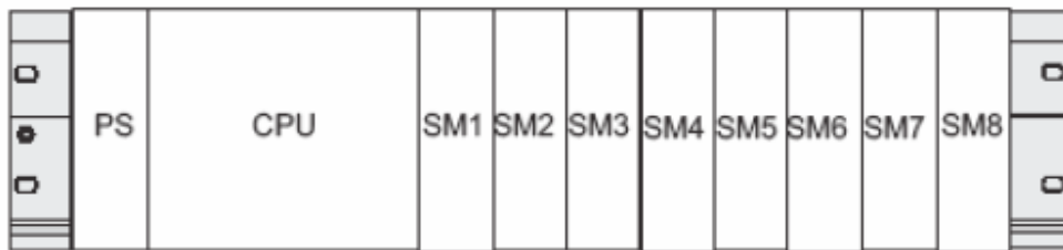
Σχήμα 1.1: Ένα Rack με ένα PLC και 8 κάρτες εισοδων/εξοδων
