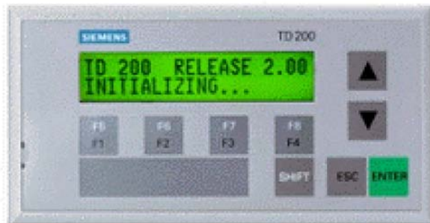
Σχήμα 2.13: Οθόνη ενδείξεων του TD 200
