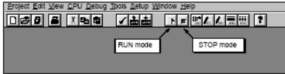
Σχήμα 4-9: Ρύθμιση του είδους λειτουργίας μέσω του STEP 7-Micro/WIN
