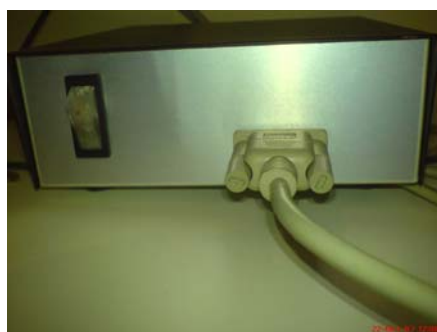
Σχήμα 2.9: Το καλώδιο RS-232 συνδεδεμένο στη θύρα της κατασκευής.
