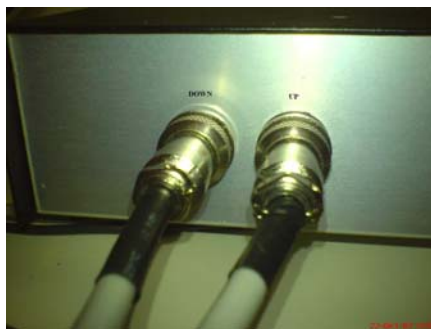
Σχήμα 2.7: Σύνδεση του καλωδίου DIN-5 με την υποδοχή "DOWN" στο κουτί.
