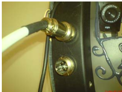
Σχήμα 2.6 : Σύνδεση του καλωδίου DIN-5 με την πάνω υποδοχή του βραχίονα.
