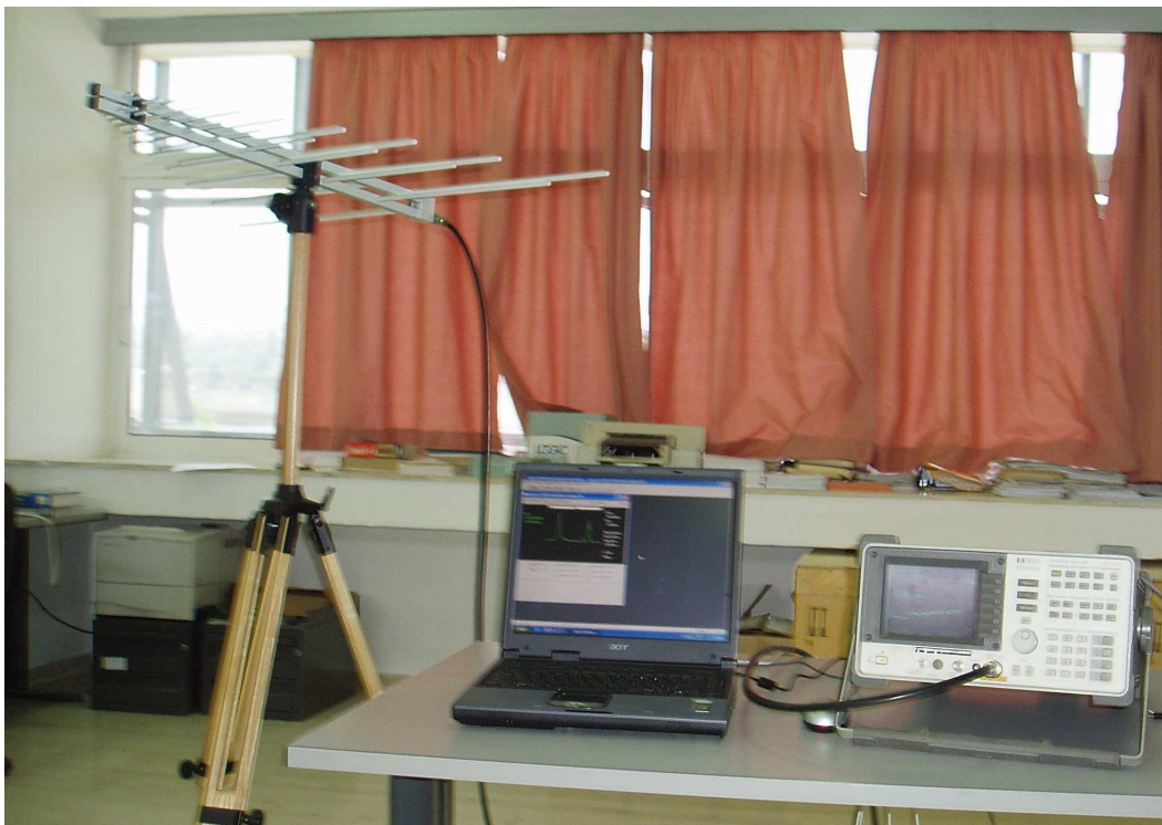
Σχήμα 38. Πραγματοποίηση μετρήσεων στα UHF IV και UHF V
