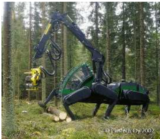
Σχ.6: ρομποτικό όχημα που χρησιμοποιείται στην μεταφορά κορμών δέντρων για την κοπή τους
