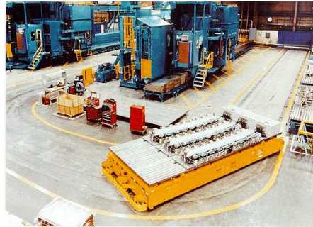
Σχήμα 1.2 AGV σε Βιομηχανικό Περιβάλλον
