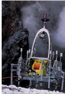
Σχήμα 1.4 Ο Dante II του Εργαστηρίου JPL της NASA κατά τη διάρκεια ανάβασης σε βουνό της Αλάσκα
