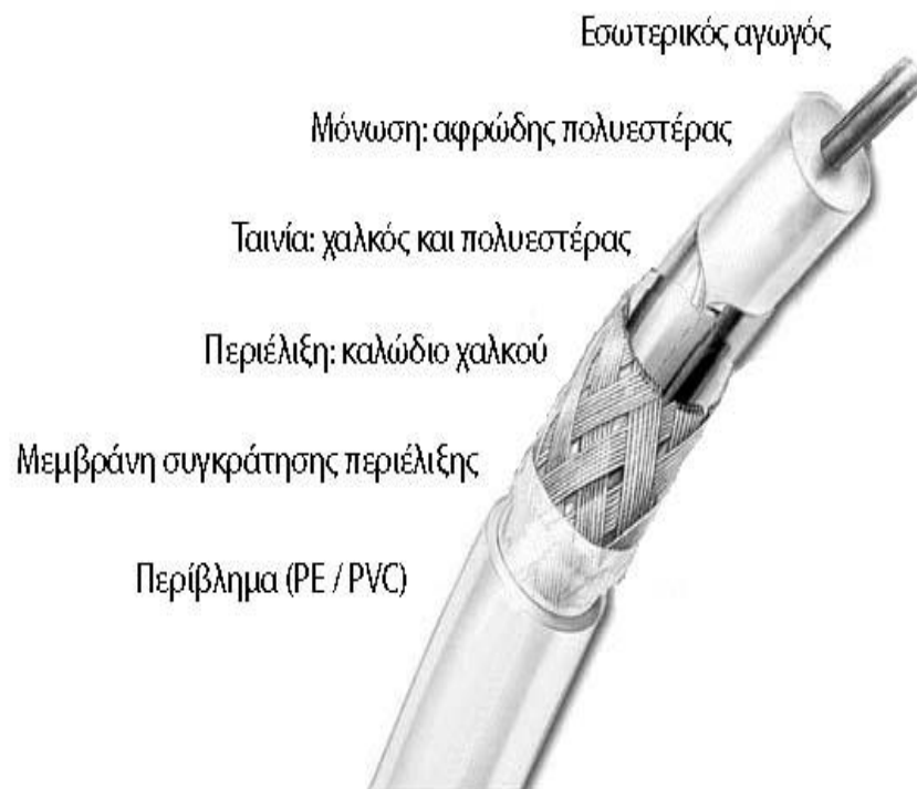
Εικόνα 50 ΔΟΜΗ ΟΜΟΑΞΩΝΙΚΟΥ ΚΑΛΩΔΙΟΥ
