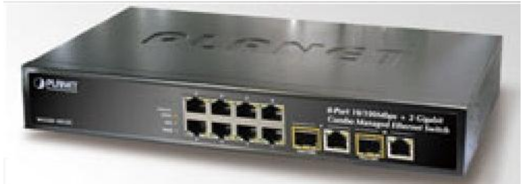
Εικόνα 26 ΜΕΤΑΤΡΟΠΕΑΣ-SPLITTER ΑΠΟ ΟΠΤΙΚΗ ΙΝΑ ΣΕ UTP
