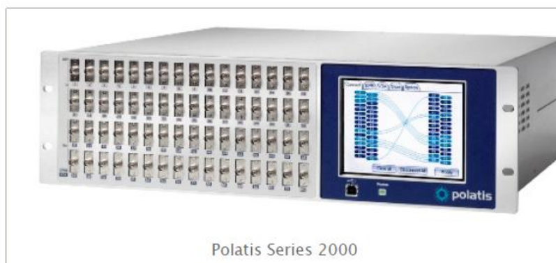
Εικόνα 21 ΟΠΤΙΚΟ SWITCH ΚΕΝΤΡΙΚΟΥ RACK
