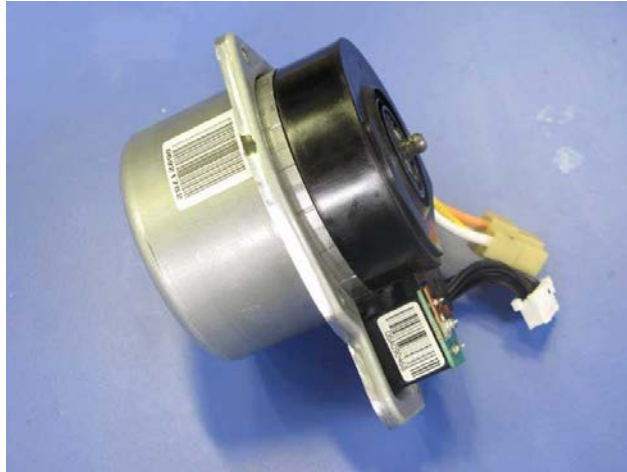
Σχήμα 47- Ηλεκτρικός κινητήρας για συστήματα διεύθυνσης EPS
