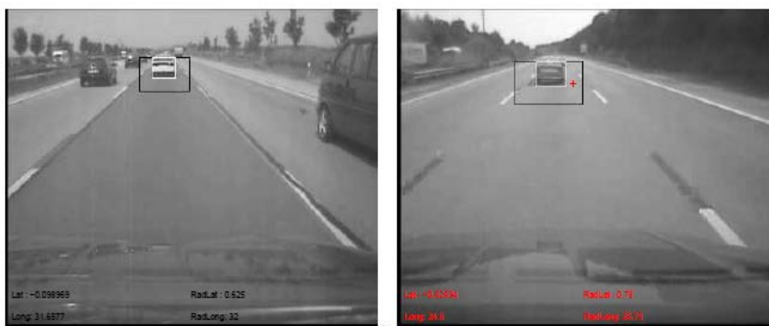
Σχήμα 27-Αποτελέσματα των δοκιμών με πόλωση του ραντάρ ενός μέτρου α)διαμήκη θέση (πραγματική 20 μέτρα) β)πλευρική θέση (πραγματική 0 μέτρα) γ)εκτιμώμενο πλάτος (πραγματικό 1.65 μέτρα)
