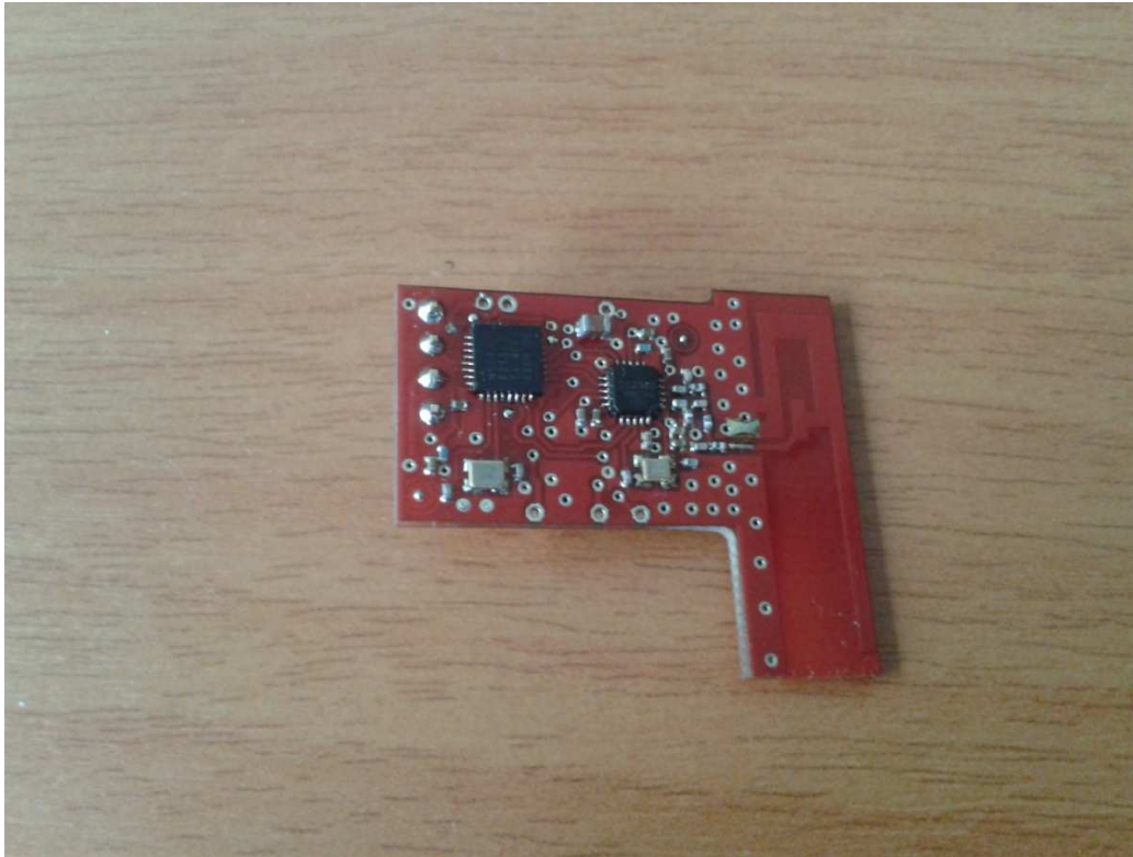
Εικόνα 3.22: Ο δέκτης του ασύρματου.
