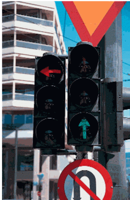
Εικόνα 1.4: Τυπική μορφή φωτεινού σηματοδότη(βέλη πορείας).
