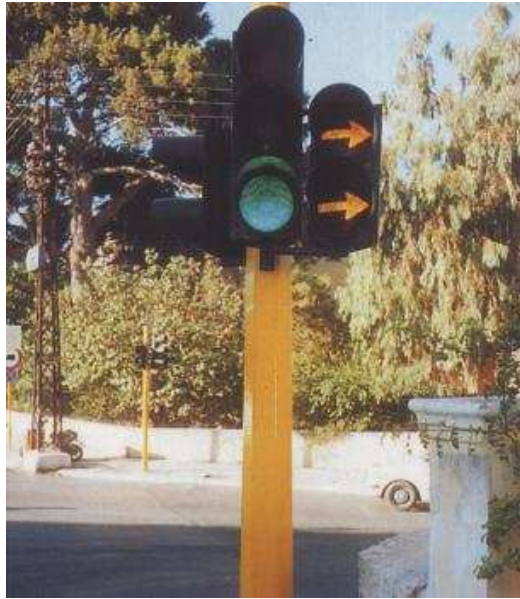
Εικόνα 1.5: Συνδυασμός κυκλικής μορφής και βέλη πορείας.
