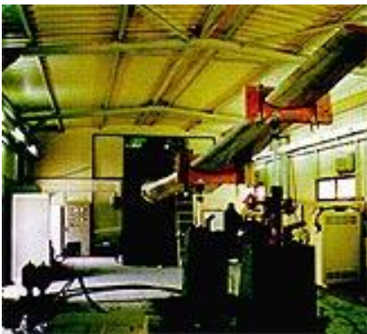
Εικόνα 8 Στατική δοκιμή αντοχής πτερυγίου
