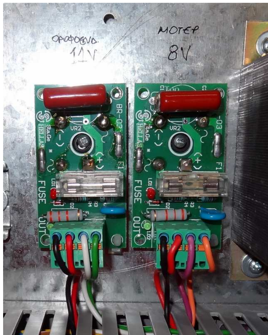
Σχήμα 3.5 Τυπωμένα κυκλώματα ανορθώσεων
