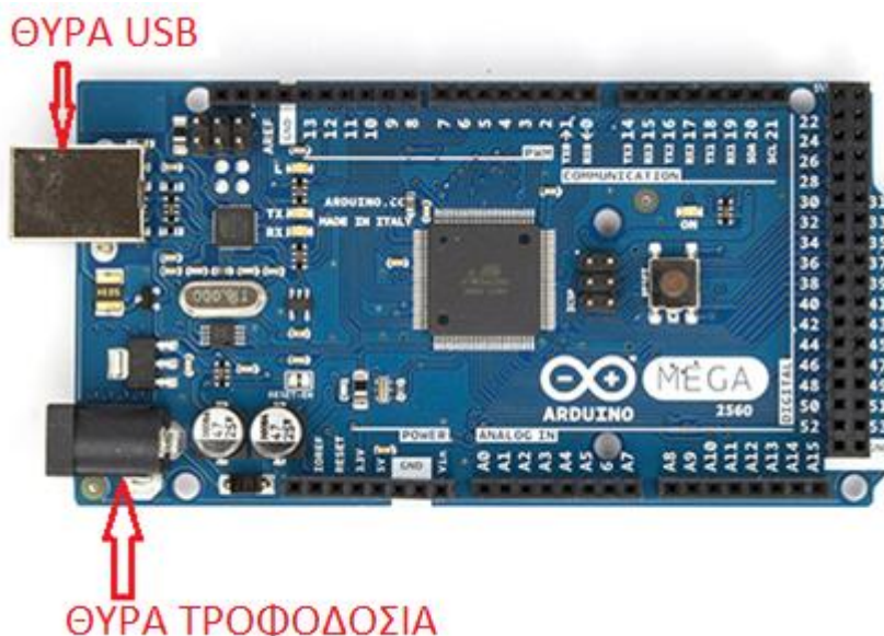
Εικόνα 2.4 : Θύρες USB και τροφοδοσίας της πλατφόρμας Arduino.
