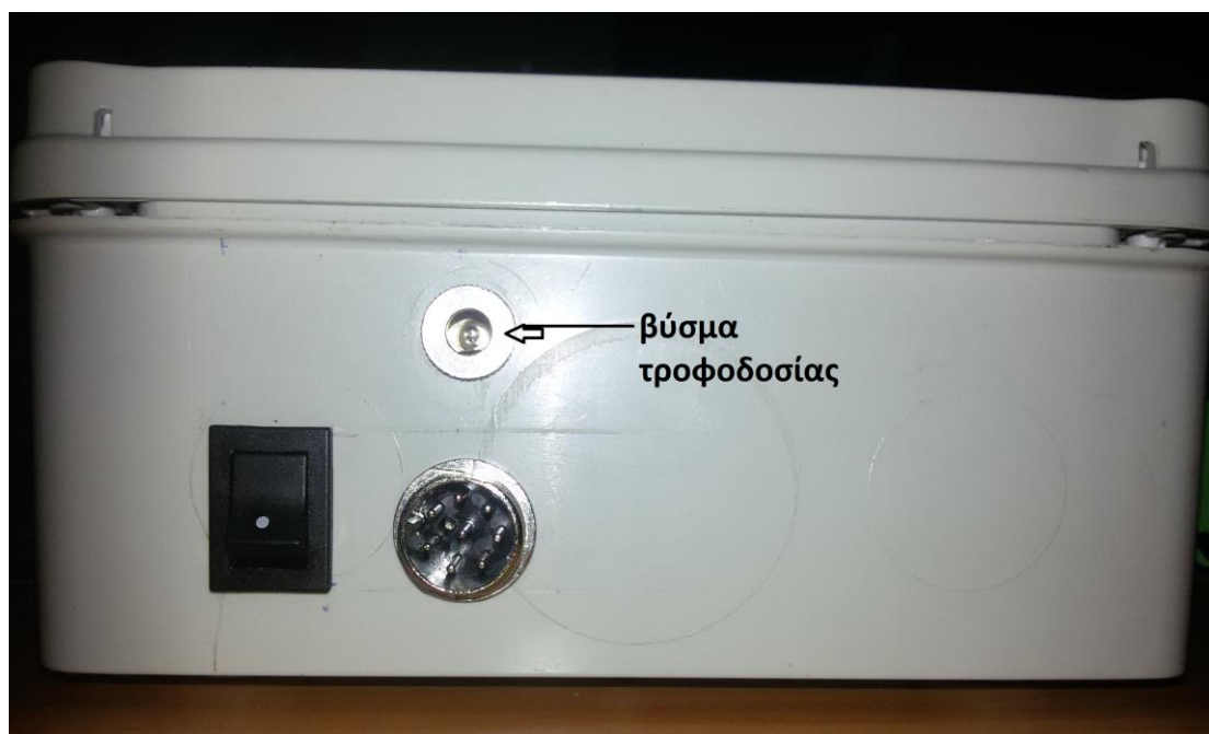
Εικόνα 6.3 Η μπροστινή όψη της συσκευής και η θέση του βύσματος τροφοδοσίας.
