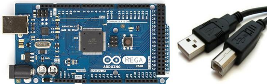
Εικόνα 3.1: Στα αριστερά η πλακέτα Arduino mega και στα δεξιά καλώδιο επικοινωνίας USB(A σε B).
