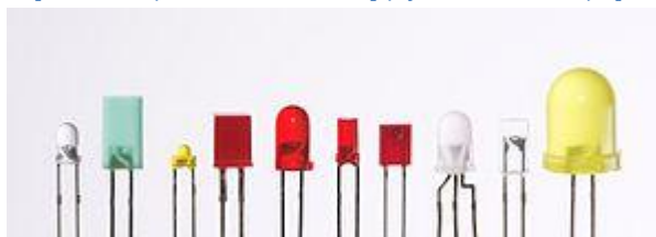
Εικόνα 4.12: Δίοδοι φωτός σε διάφορα χρώματα και μεγέθη
