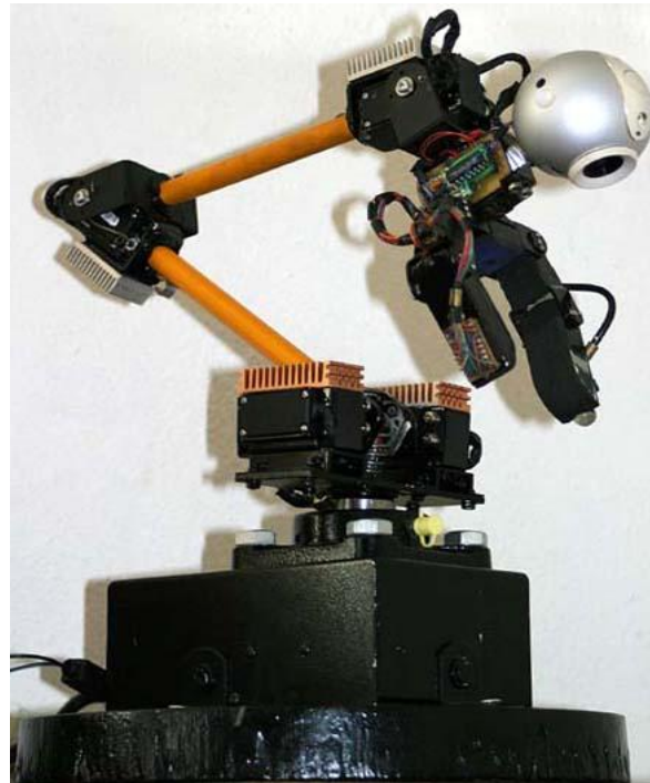
Σχήμα 2.3 Εκπαιδευτικός βραχίονας με προσθήκη αισθητήρων όρασης και αφής
