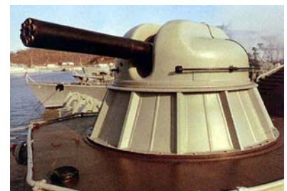
Εικόνα 1.4 Αντιαεροπορικό πυροβόλο ελεγχόμενο από Ραντάρ
