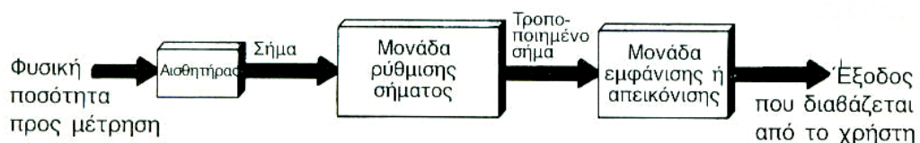
Εικόνα 1.11 Λειτουργικά στοιχεία ενός συστήματος μέτρησης
