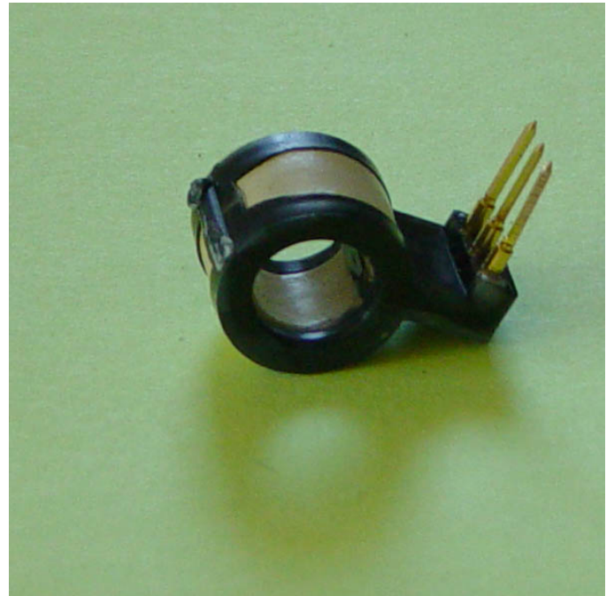
Εικόνα 3.3 Τυπικός αισθητήρας ρεύματος
