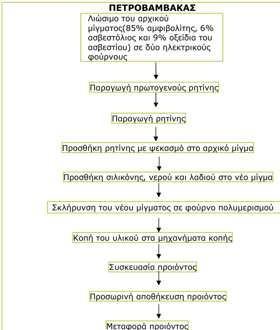
Σχεδιάγραμμα 4.15 Διαδικασία παραγωγής πετροβάμβακα.
