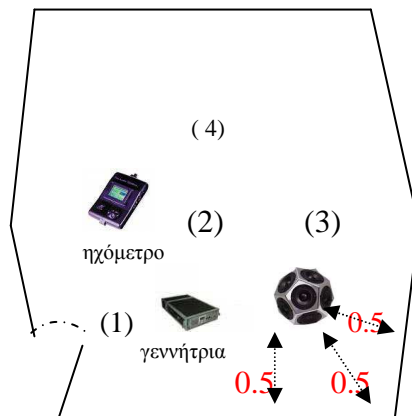
Σχήμα 6.6 Διάταξη της μέτρησης του χρόνου αντήχησης στο control room. Οι θέσεις μετρήσεων του ηχομέτρου είναι αντίστοιχα οι: (1), (2), (3), (4).
