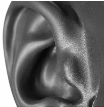
Εικόνα 6: Έχει δοθεί ιδιαίτερη προσοχή στην προσημείωση του πτερυγίου του αυτιού, καθώς είναι γνωστός και ιδιαίτερος ρόλος του κατά την ακρόαση.
