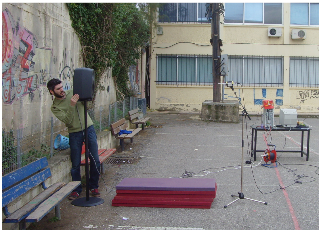
Σχήμα 24. Φωτογραφία από το χώρο των μετρήσεων όπου φαίνεται η 2 η πειραματική διάταξη και τα απορροφητικά υλικά για την απορρόφηση της ανάκλασης από το πάτωμα .
