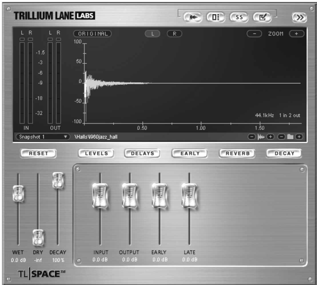
Εικόνα 22: Reverb για σόλο φωνές. TL Space της Trillium Lane Labs με κρουστική απόκριση από Lexicon 960. Jazz Hall.
