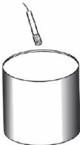
Σχήμα 63: Παρόμοια τοποθέτηση με το μικρόφωνο για σνερ, εδώ για τομ. Δυναμικό, κοντά, και στοχεύει προς το κέντρο της μεμβράνης. Μπορούσε να είναι και κλιπ-ον.
