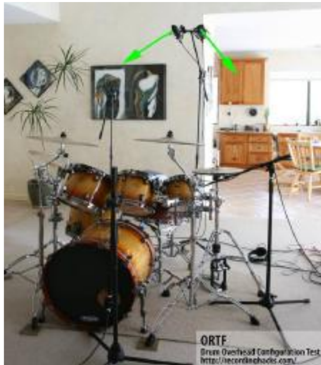
Σχήμα 68: Το overhead στερεοφωνικό ζευγάρι, ημι-συμπίπτων ortf
