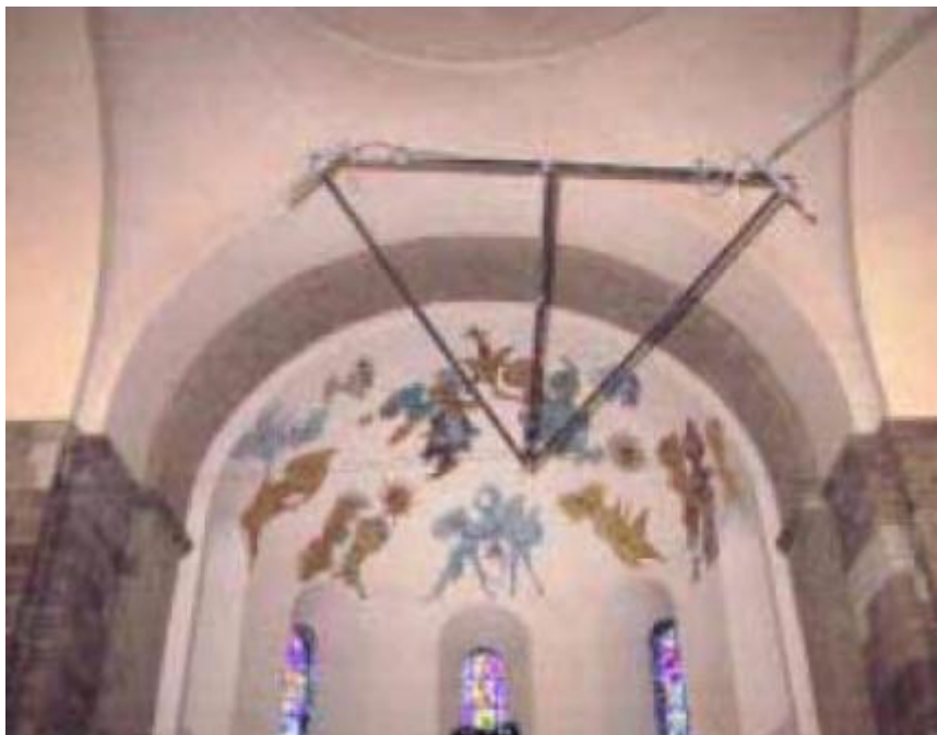
Σχήμα 95: εικόνα από την ηχογράφηση του Μεσσία του Χέντελ με τη μέθοδο Decca tree + ORTF στον καθεδρικό ναό του Ribe στη Δανία για τηλεοπτική παραγωγή του 2001
