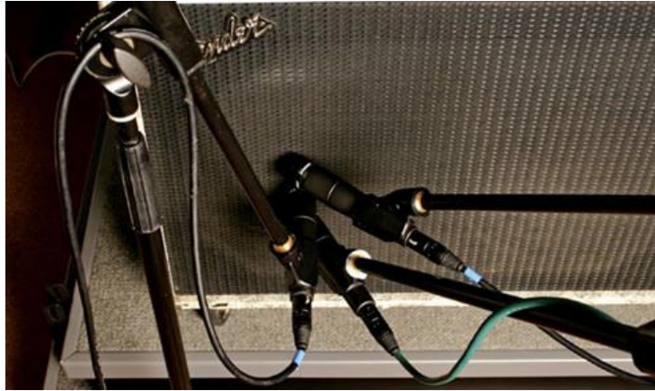
Σχήμα 82: Τοποθέτηση μικροφώνων σε σχέση με τη γωνία κλίσης του μικροφώνου ως προς τον κώνο.
