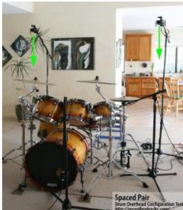
Σχήμα 69: Το overhead στερεοφωνικό ζευγάρι, απομακρυσμένη τεχνική που βασίζεται στην διαφορά φάσεων (χρόνου άφιξης των ίδιων ήχων στα 2 μικρόφωνα) για δημιουργία της στερεοφωνικής εικόνας. Πιο εντυπωσιακό αποτέλεσμα, πιο ανοιχτή και ευρεία στερεοφωνία, αλλά πιο ριψοκίνδυνη όσο αφορά τις ακυρώσεις φάσεως.
