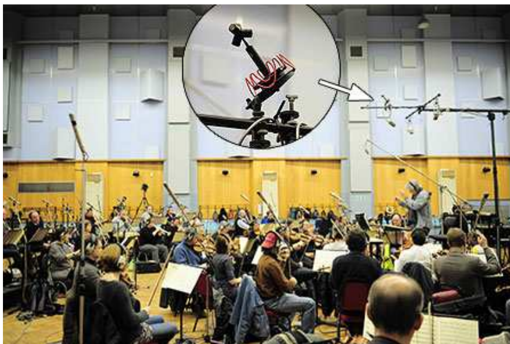
Τοποθέτηση surround μικροφώνου για ηχογράφηση ορχήστρας σε πραγματικές συνθήκες
