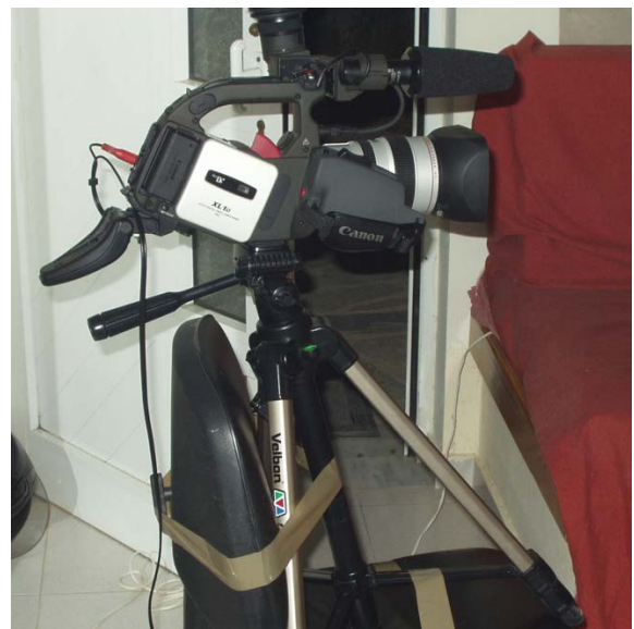
Αυτοσχέδια κατασκευή για ομαλή κίνηση της κάμερας στο χώρο
