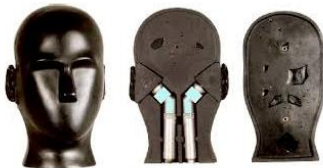
ΕΙΚΟΝΑ 19 : Ομοίωμα ανθρώπινης κεφαλής. Εσωτερικά (στο μέρος των αυτιών) τοποθετήθηκαν δυο πυκνωτικά μικρόφωνα.
