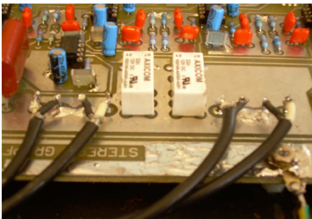
Εικόνα 19 (Είσοδος και έξοδος της συσκευής στην πλακέτα των φίλτρων)
