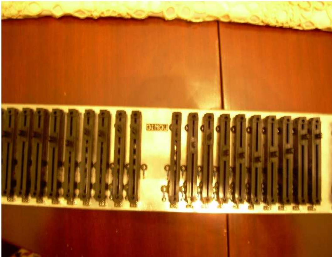
Εικόνα 2. Η πλακέτα των ποτενσιόμετρων
