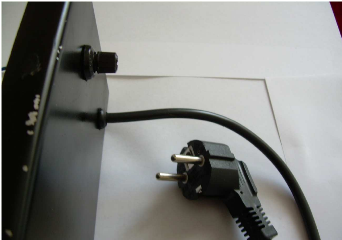
Εικόνα 20 (Πίσω όψη της συσκευής, καλώδιο τροφοδοσίας και ασφάλεια)
