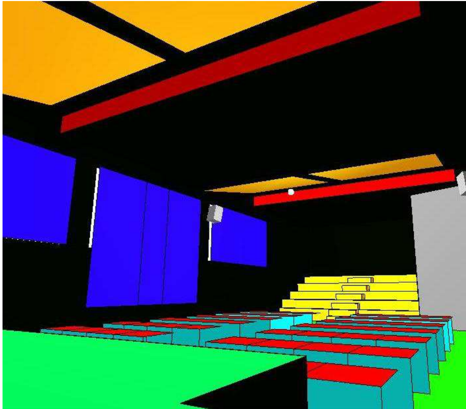
Σχήμα 7.5.2. Τοποθέτηση απορροφητικών διατάξεων στην οροφή (κόκκινο χρώμα).
