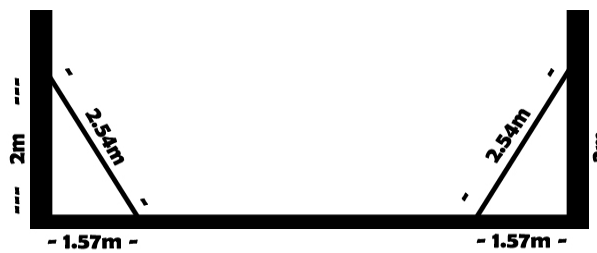
Σχήμα 8.3.6. Διαστάσεις πλαϊνών ανακλαστικών επιφανειών.
