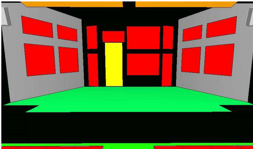
Σχήμα 7.7.1. Τοποθέτηση απορροφητικών υλικών στη σκηνή (κόκκινο χρώμα).
