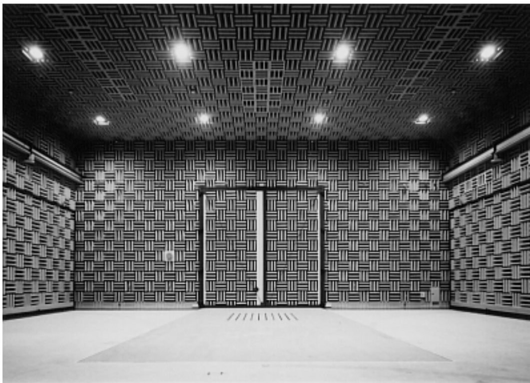
Σχήμα 3.1. Ένα από τα μεγαλύτερα ανηχοϊκά δωμάτια του κόσμου που αποτελεί τον πυρήνα των ακουστικών εργαστηριακών δοκιμών στη πόλη Hiratsuka.
