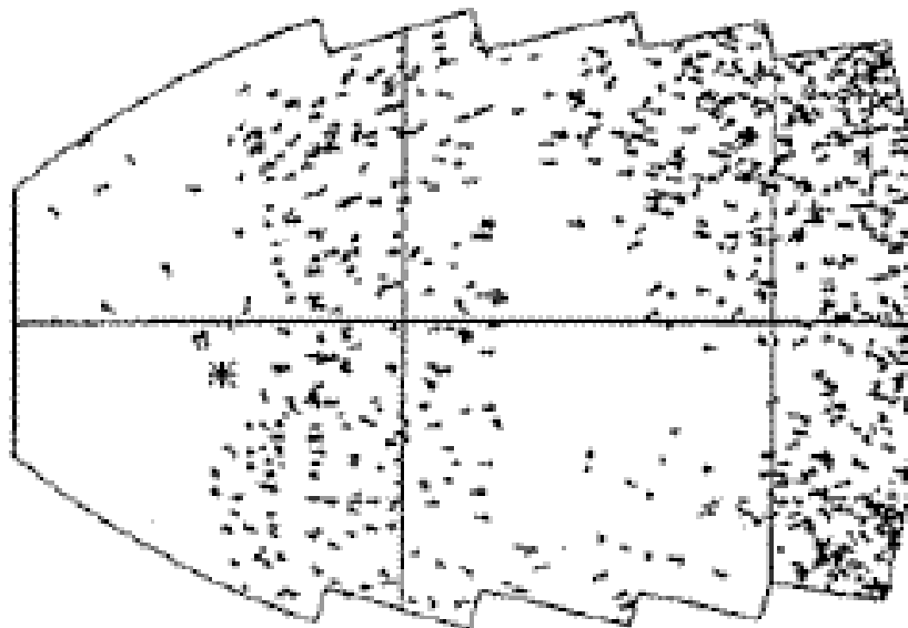
Σχήμα 5.1.7. Τεχνική Ray-Tracing στην περιοχή ακροατηρίων. Συγκέντρωση στο οπίσθιο μέρος της αίθουσας σε χρονικό διάστημα 50-100ms μετά από τον άμεσο ήχο. Αίθουσα συναυλιών του Γκέτεμποργκ (Χτίστηκε το1935) [3].
