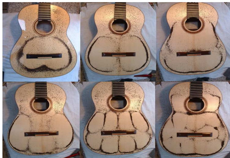
Εικόνα 2.10: Κανονικοί τρόποι δόνησης του καπακιού κιθάρας καταγεγραμμένοι με την μέθοδο Chladni.
