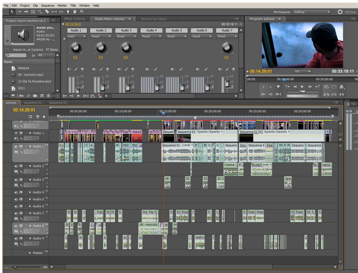
Εικόνα 29 Τελική μορφή του timeline του ήχου, μετά την εισαγωγή όλων των ήχων της ταινίας
