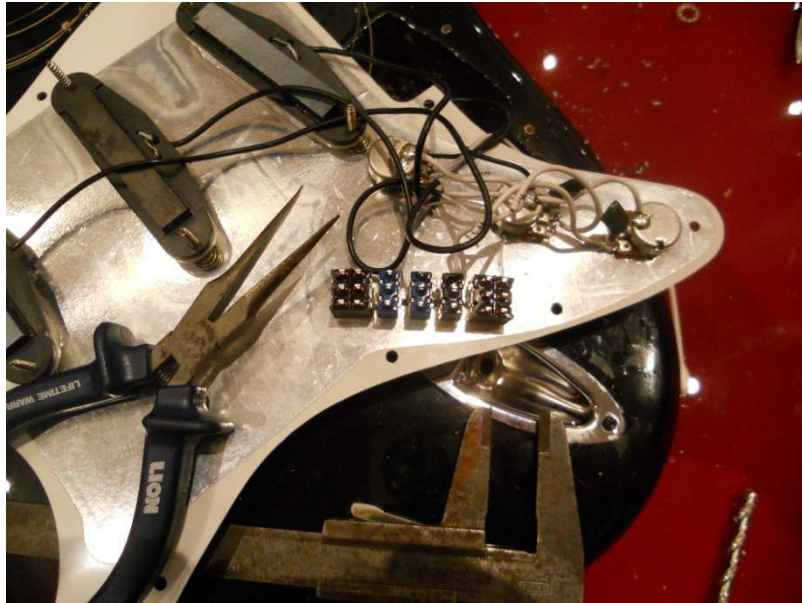
Εικόνα 25. Τελική τοποθέτηση και των πέντε διακοπών. (Πηγή : προσωπικό αρχείο)
