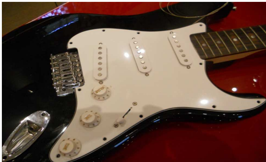
Εικόνα 20. Αρχικός διακόπτης 5 θέσεων (εξωτερική όψη). (Πηγή : προσωπικό αρχείο)
