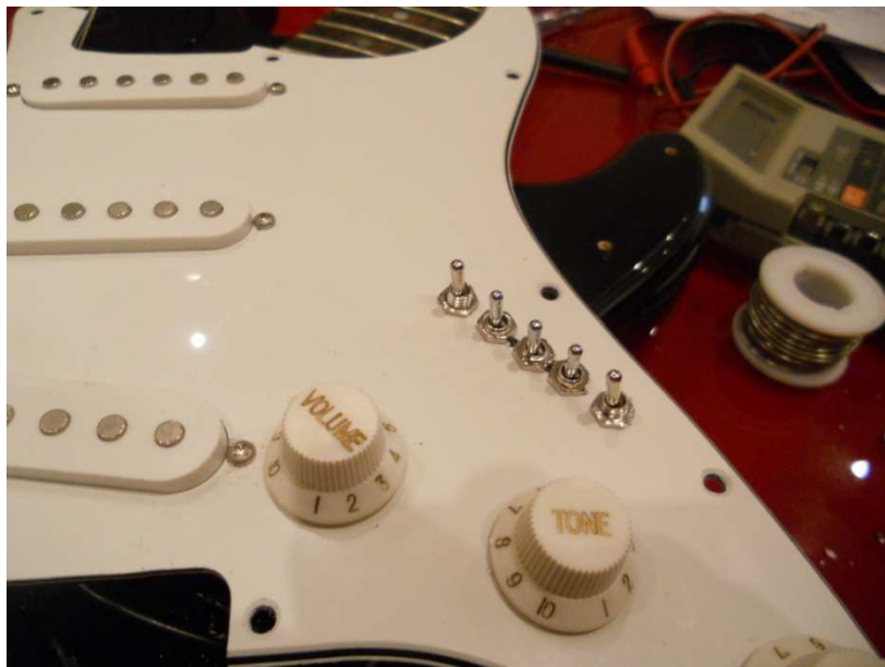
Εικόνα 26. Εξωτερική όψη κιθάρας με τους πέντε διακόπτες στην θέση τους. (Πηγή : προσωπικό αρχείο)
