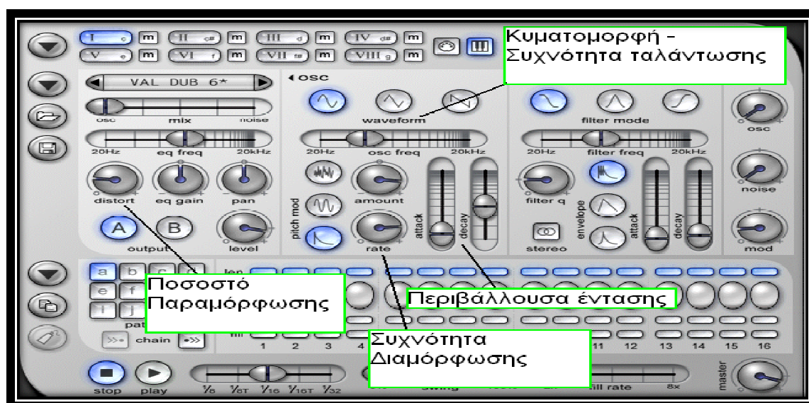
Εικ. 4.3.2 – Δημιουργία χροιάς της ατάκας της μπότας μέσω του microtonic. ( Σημειώνεται ότι οι τιμές της συχνότητας ταλάντωσης και των χρόνων της περιβάλλουσας είναι λογαριθμικής κλίμακας)
