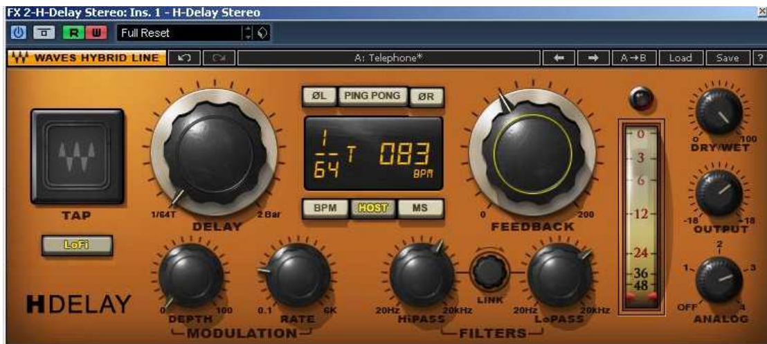
Εικ. 4.4.8 - Το HDelay της Waves με ενεργοποιημένο το Lo Fi αριστερά και ρυθμισμένο κατάλληλα tempo στα 83 Bpm.
