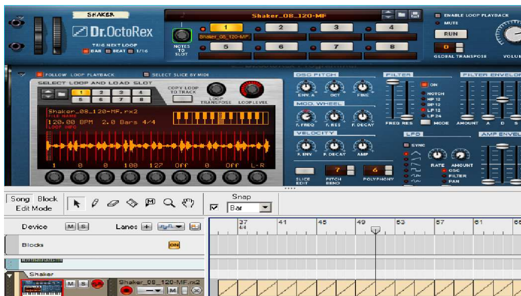
Εικ.4.5.1 – (Πάνω) εισαγωγή του δείγματος στο Dr.OctoRex και (κάτω) η τοποθέτηση της λούπας ανά μέτρο.
