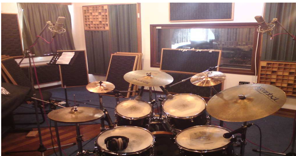
Εικ.2.1.5 Η τοποθέτηση των μικροφώνων στο drum set κατά την διάρκεια του recording session.
