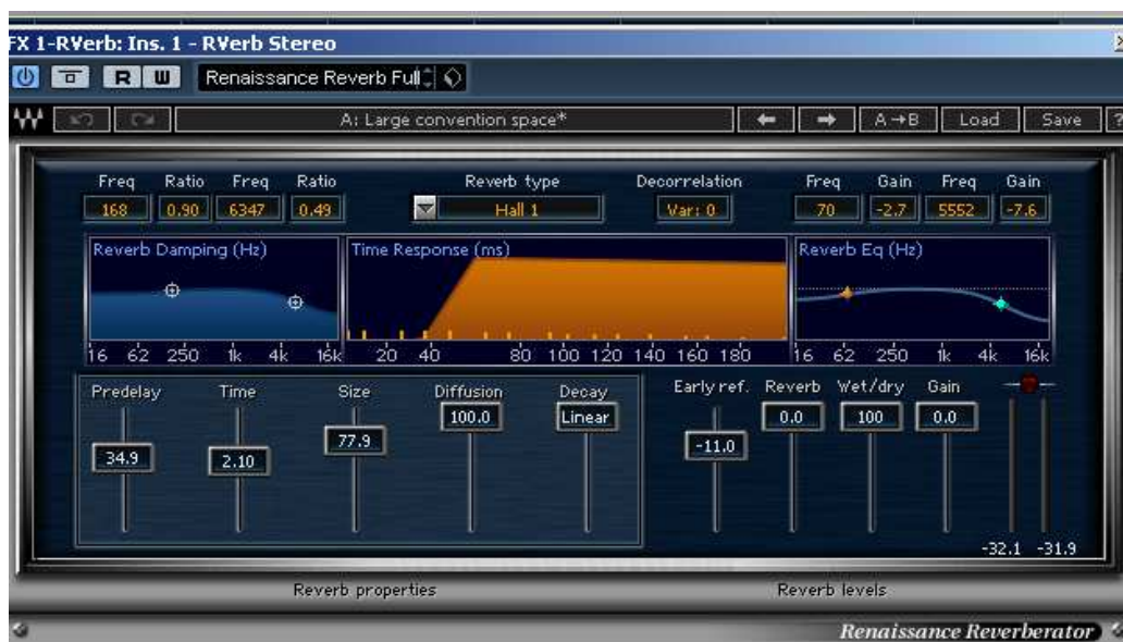
Εικ.4.4.6 - Προσομοιωτής αντήχησης Rverb της Waves.
