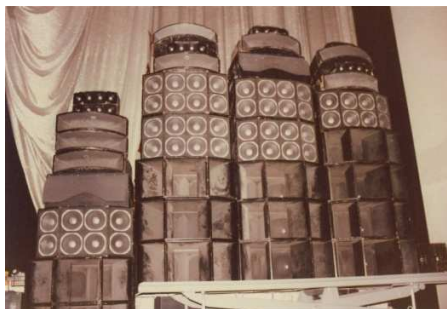
Φωτο (1) και (2) στοίβες από ηχεία bass, mid bins και κόννες
