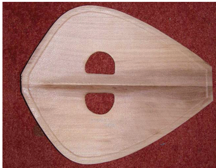
Σχήμα 1.2 Τυπικό καπάκι κρητικής λύρας υπό κατασκευή. Κατά μήκος του οργάνου παρατηρούμε την μπάρα που προσδίδει ανθεκτικότητα.
