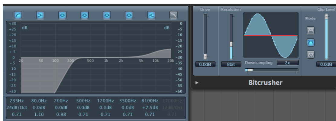
Εικόνα 16. Το EQ και το Bit-crusher του Logic που χρησιμοποιήθηκαν για την δημιουργία του συμπαγούς hi-hat.
