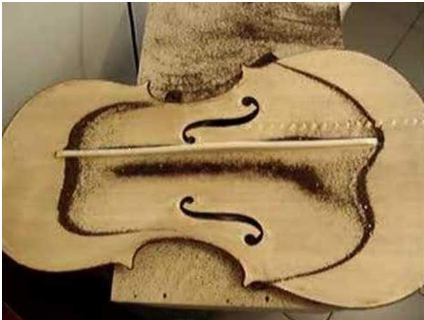
Εικόνα 1-5: Chladni figure εφαρμογή σε τσέλο
