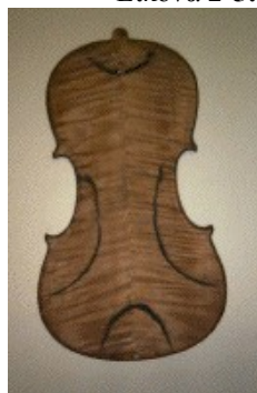
Εικόνα 3-5: Chladni figure εφαρμογή σε βιολί
